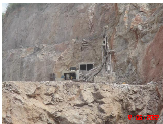
รูปที่ 2-10 รถเจาะรูระเบิดที่มีอุปกรณ์เก็บฝุ่นติดไว้กับหัวเจาะ
